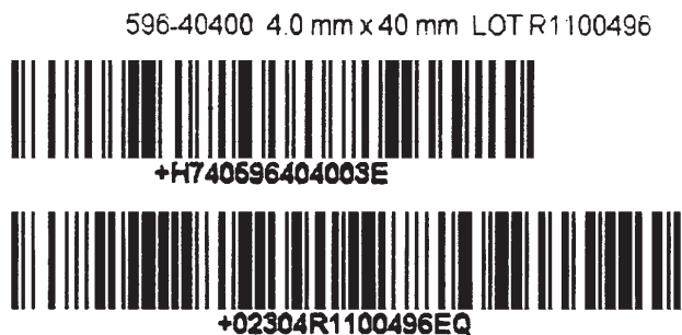
Figura 1. Codici primario e secondario secondo lo standard HIBC. Nel primo codice (codice primario) è possibile identificare il codice della ditta (H740) e il codice del prodotto (596-40400). Nel codice secondario l'anno e il giorno (304° giorno del 2002) e il numero di lotto (R1100496).
