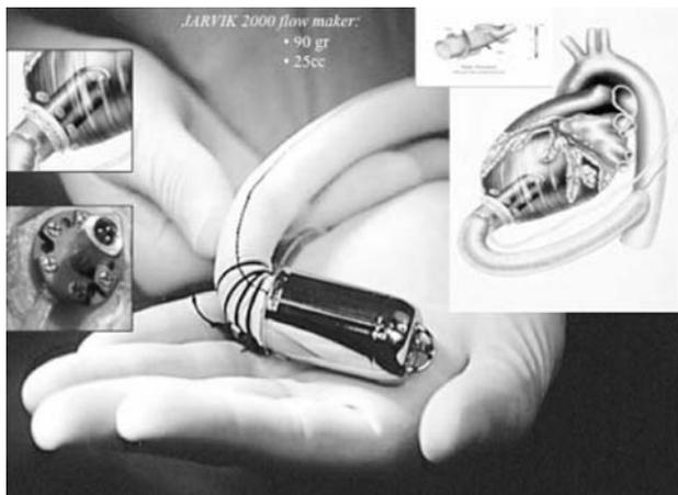
Figura 9. Jarvik 2000 Flowmaker. Nei riquadri gli aspetti specifici del dispositivo: impianto intraventricolare, raccordo retroauricolare, connessione aorta toracica discendente.
