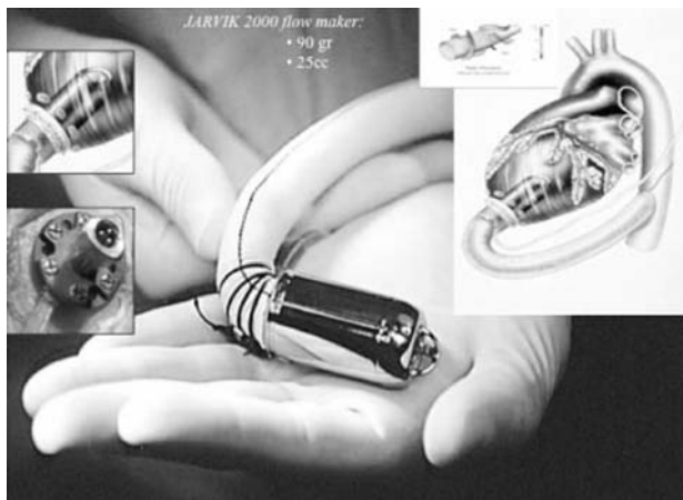
Figura 9. Jarvik 2000 Flowmaker. Nei riquadri gli aspetti specifici del dispositivo: impianto intraventricolare, raccordo retroauricolare, connessione aorta toracica discendente. Fonte: JarvikHeart, www.jarvikheart.com .
