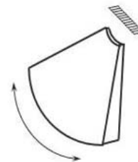
Settore Phased Array
